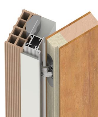
MONTAJE TIPO 4: FILOMURO ENLUCIDO LADO CONTRARIO BISAGRAS
